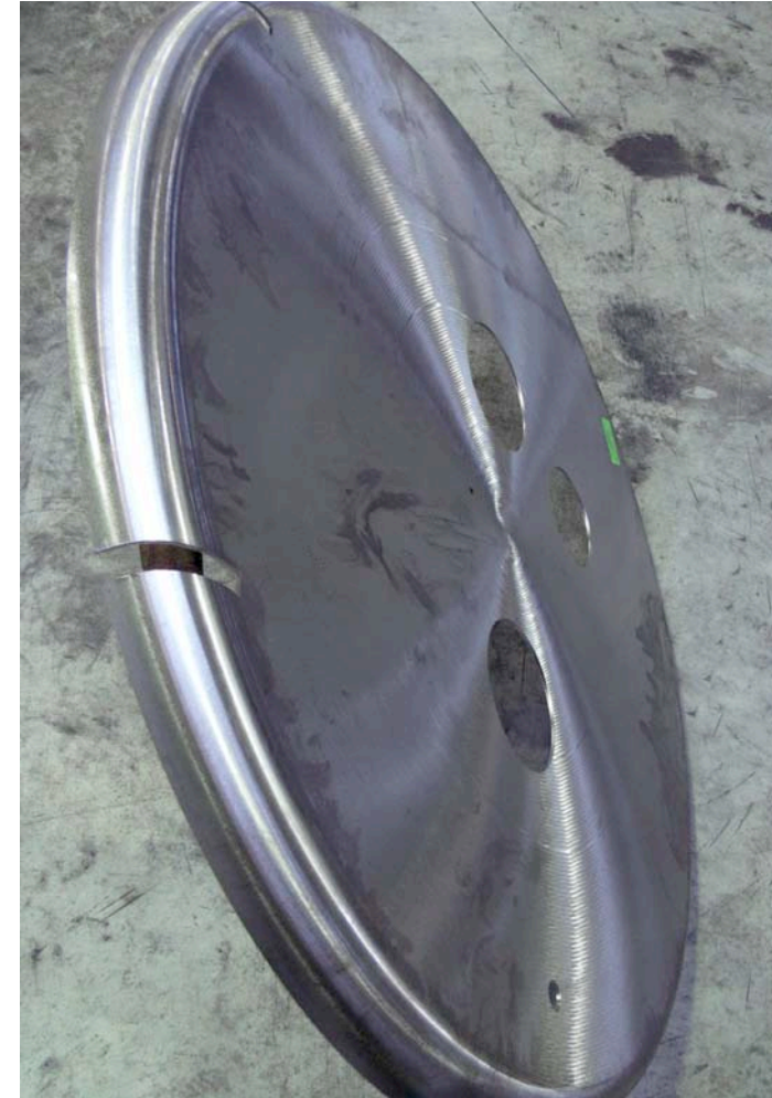
3D Laserschritte in Kesseldeckel
