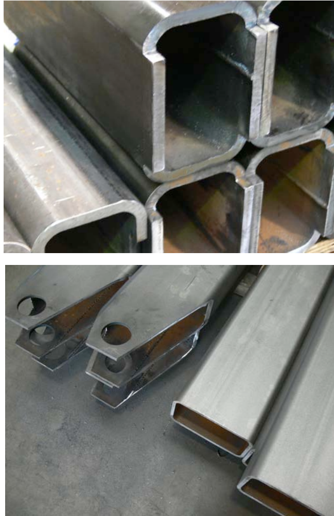
3D Konturierung von Profilrohr
