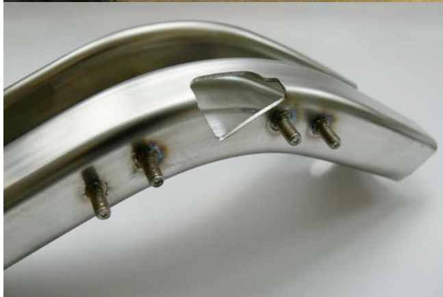
3D Präzisions-Laserschnitte als Profilschnitt
