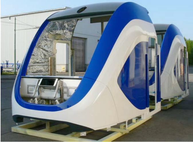
Beispiele für Blechbaugruppen für die Fertigung von Strukturen und von fertigen Baugruppen zum Einbau in die Schienenfahrzeugrahmen
