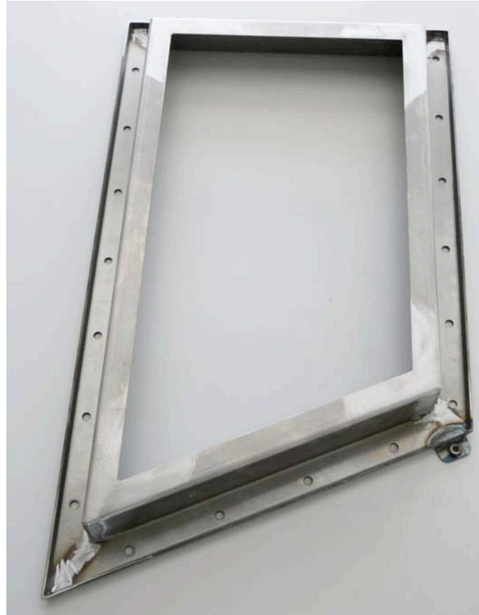
Beispiele für Blechbaugruppen für die Fertigung von Strukturen und von fertigen Baugruppen zum Einbau in die Schienenfahrzeugrahmen
